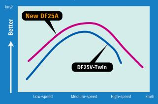
**Top Speed Comparison** (New DF25A vs. DF25V-Twin) (DF25V-Twin Max. Speed = 100%)
